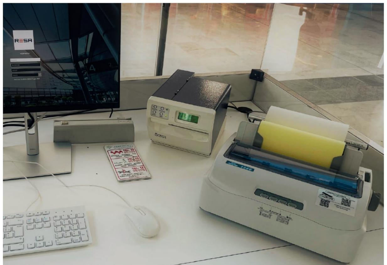
am Gate notwendig sind. In enger Kooperation mit RESA wurde der Tally Dascom 1140 an die Software-Umgebung von RESA adaptiert und eine Rollenhalterung entwickelt. Dann erfolgte die Zertifizierung des Druckers. In einer ersten
