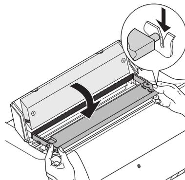
Incline levemente o cartucho de fita e coloque a fita entre o suporte de impressão transparente e a aba de inserção verde. Alinhe a fita e coloque-a pelas guias à esquerda e à direita. Pressione até ouvir um clique.
