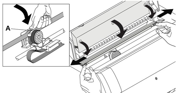
Pressione para abaixo o suporte de inserção verde **A**. Mova o cabeçote de impressão para os lados para que o mecanismo de impressão tensione automaticamente a fita. Pressione o mecanismo de fricção para baixo até ajustá-lo no seu lugar. Feche a tampa superior.
