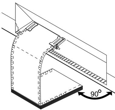
Assegure-se de alinhar a pilha de papel paralelamente com a impressora, e que o fluxo do papel esteja livre de obstruções. Feche a tampa frontal.
