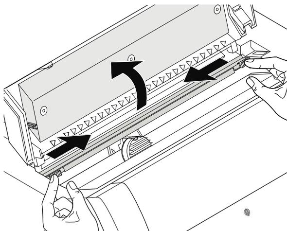
Ligue a impressora. Abra a tampa superior. Mova as guias de tração verde localizadas à direita e à esquerda e levante o mecanismo de tração.
