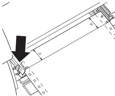
Abra a alavanca/trava verde e alinhe o trator de forma que a primeira posição de impressão no papel esteja em linha com a marca **X** no gabinete da impressora. Coloque a alavanca na posição travado. Coloque o formulário no trator esquerdo.
