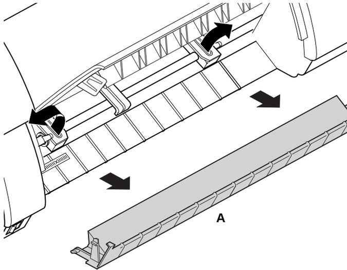
Levante a tampa frontal. Remova a tampa inferior **A**. Abra as abas direta e esquerda dos tratores.
