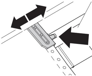
Desserrer le levier de verrouillage du tracteur de droite et l'ajuster sur la largeur du papier. Charger du papier continu dans le tracteur. Veiller à ce qu'il soit à la même hauteur que dans le tracteur de gauche pour éviter un bourrage du papier. Refermer le volet du tracteur et bloquer le tracteur en basculant le levier vers l'arrière.
