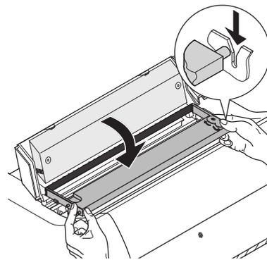
Inclinez légèrement la cassette ruban vers l'arrière pour la glisser et la mettre en place. Le ruban doit être inséré entre le film protecteur transparent et le guide vert qui est devant la tête. Vous aurez bien sûr pris la précaution de lever celui-ci qui sert ainsi de guide pour la mise en place main propre du ruban. Après la mise en place de la cassette et du ruban, il faut bien vérifier que celle-ci a fait un clic sur la gauche et sur la droite dans les encoches de maintien.
