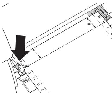
Ouvrir le levier de verrouillage vert et aligner le tracteur de façon à ce que la position du début d'impression sur le papier coïncide avec le repère **X** sur le carter de l'imprimante. Rebloquer ensuite le levier. Charger du papier continu dans le tracteur de gauche.
