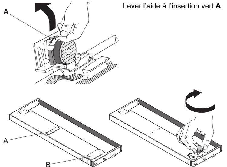
Retirez les protecteurs verts **A** et **B**. Insérer la molette verte et tournez dans le sens des aiguilles d'une montre.
