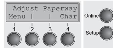
**Setup:** Règle l'imprimante en mode Setup dans lequel les réglages suivants peuvent être sélectionnés:
