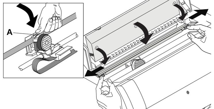
Appuyer l'aide à l'insertion vert **A** vers le bas. Déplacez la tête d'impression et son chariot de gauche à droite. Si le ruban est bien en place, ce mouvement vous permettra de voir le ruban avancer. Dans le cas contraire, la cassette ruban n'est pas correctement positionnée. Appuyer le dispositif de friction vers le bas jusqu'à ce qu'il s'enclenche. Fermer la partie avant du capot supérieur.
