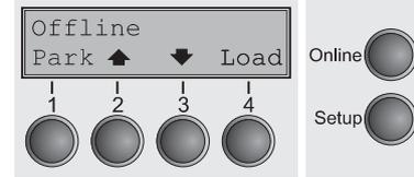
L'alimentation pas à pas, le changement de ligne ou de page ne peuvent être effectués via le panneau de commande que dans ce mode. Il n'est cependant pas possible de recevoir des données.
