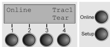
Dès que l'imprimante est mise sous tension, elle passe automatiquement en mode Online. Elle ne peut recevoir des données de l'ordinateur que dans ce mode.
