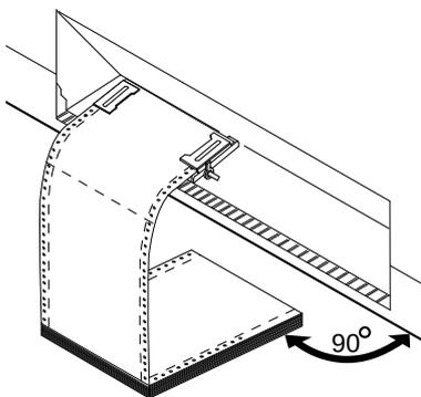
Veiller à ce que la pile de papier soit alignée parallèlement à l'imprimante et que le flux de papier ne soit pas entravé.
